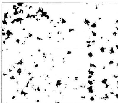
图 C.0.1-4 腐蚀面积率 8%
