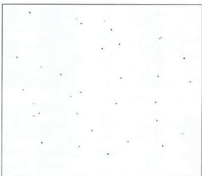
图 C.0.1-1 腐蚀面积率 0.05%
