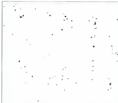
图 C.0.1-2 腐蚀面积率 0.5%
